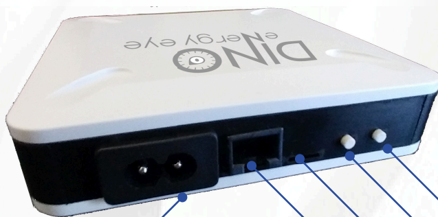
ALIMENTAZIONE (utilizzare l'apposito cavo C8 di alimentazione in dotazione)
